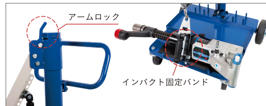
移動時はアームロック及びインパクト固定バンドにより、安全に移動が可能で、収納もコンパクトです。
