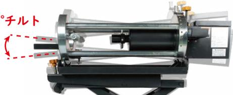
角度調整ねじを回せば上下±5°チルト！ブッシュ交換時に車体やブッシュの角度に合わせて微調整が可能！
