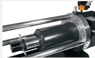
長崎独自のエアポンプ体式シリンダー搭載！ボタン1つでピストンロッドが前進、リリースバルブを緩めれば後退、簡単操作！
