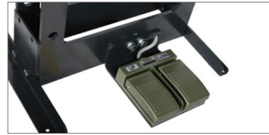
ご使用条件にあわせて、標準搭載のボタンスイッチ仕様からフットスイッチ仕様への変更が可能。
