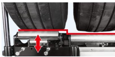
昇降機能付分離ローラーを上昇させ、段差を付けることによりダブルタイヤのシングル外しが可能！
