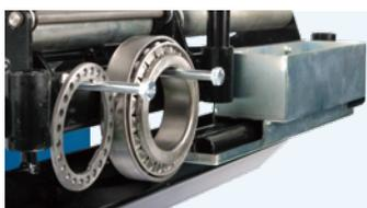
取外したハブベアリング等を収納できるボルトフックが4本標準で付属！受台の両サイドにあるボルト穴計9ヶ所と、パンチングパネル部に取り付けが可能！
