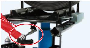
回転解除ハンドルを下げると、受け台が180°回転！受け台の両端で前輪2軸車のタイヤ及び、ダブルタイヤのシングル外しが可能に！
